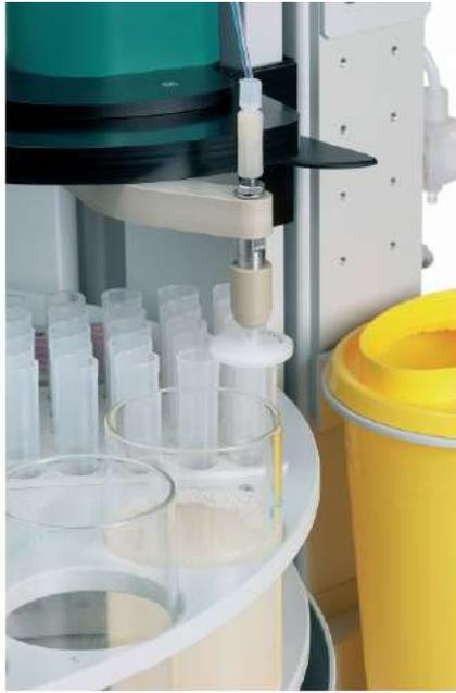
Filtración totalmente automática: El 815 Robotic Filtration Soliprep filtra las partículas sólidas que quedan en la muestra homogeneizada. El producto residual es un líquido transparente que se puede inyectar directamente en el analizador o diluir todavía más.
