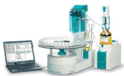
El 874 Oven Sample Processor con 852 Titrand
