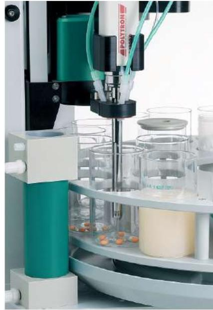
Preparación de muestras totalmente automática y análisis de comprimidos: Después de la adición del disolvente, el homogenizador de alta frecuencia Polytron tritura los comprimidos directamente en el recipiente de la muestra. Cada muestra es procesada exactamente del mismo modo.
